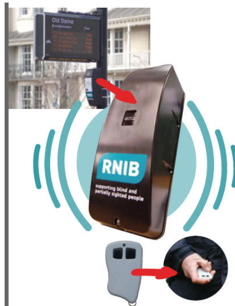
圖 2.3.10 英國 Brighton & Hove 地區之 Talking bus stops 系統構成圖
