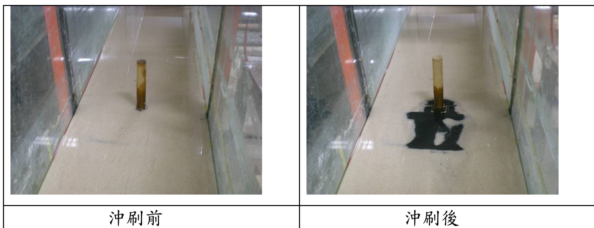
照片7.13 砂腸袋工法沖刷前後之照片( D/D^* = 0.7 ， V/V_c = 1.1 )
