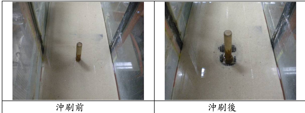
照片7.11 格籠工法沖刷前後之照片( D/D^*=0.7 ， V/V_c=1.1 )
