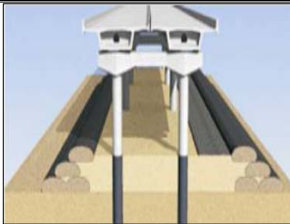
圖2.31 韓國仁川跨海大橋砂腸管配置示意圖
