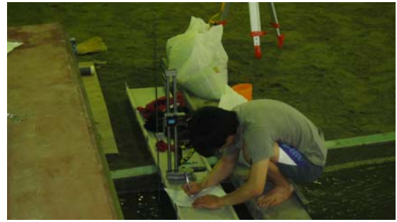
照片9.2 電子式高度計量測水位照片
