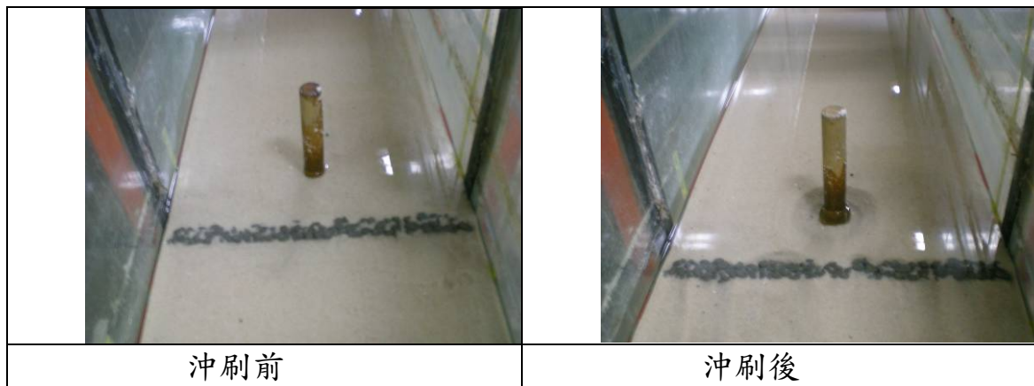
照片7.17 透水混凝土工法沖刷前後之照片( D/D^* = 0.7 ， V/V_c = 1.1 )
