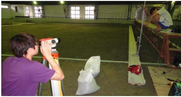
照片9.1 水準儀量測橋面高程照片
