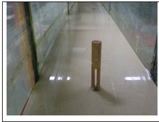
照片 7.18 橋墩開口工法試驗布置照片
