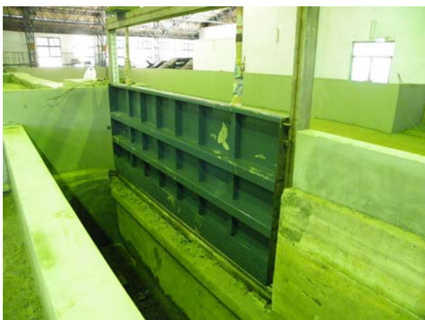
照片8.7 高擋水磚牆率定用閘門製作
