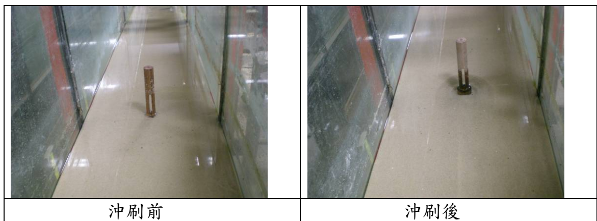
照片7.19 橋墩開口工法冲刷前後之照片( D/D^*=0.7 ， V/V_c=1.1 )
