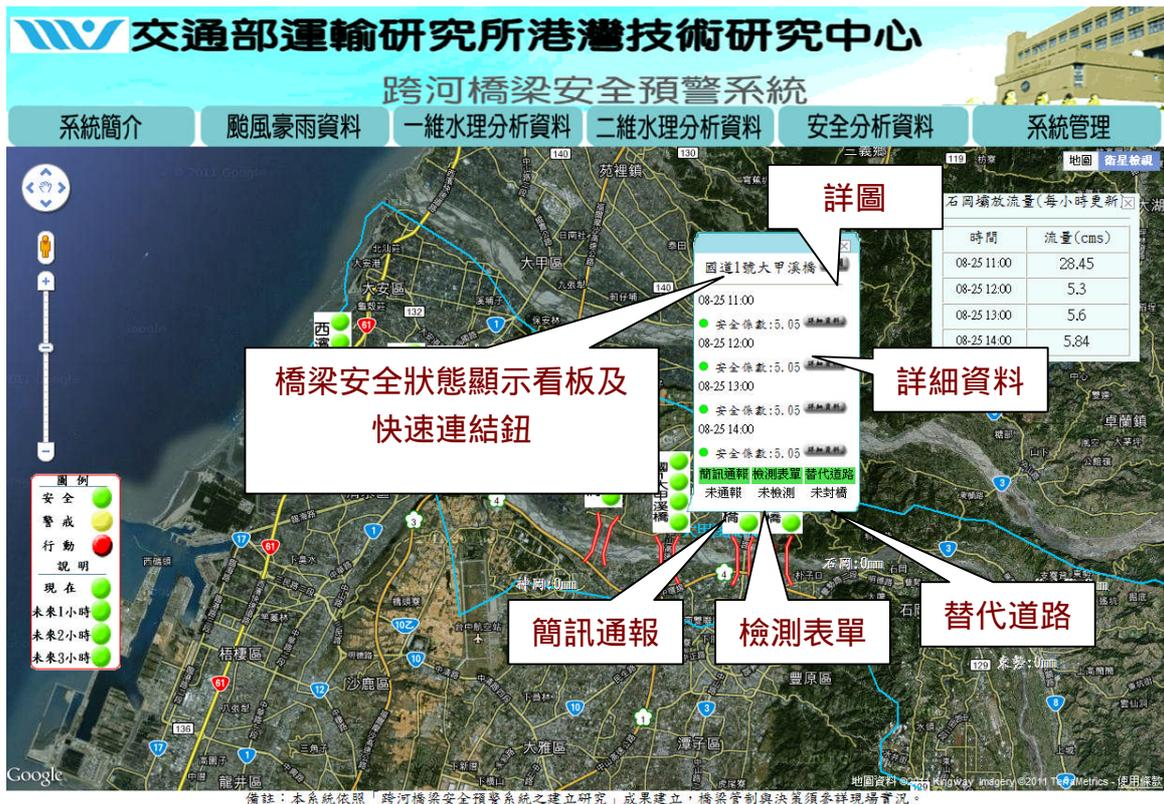
圖 9 橋梁安全狀態顯示看板及快速連結鈕
