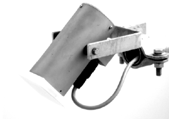
圖5.18 脈衝式微波雷達流速儀
