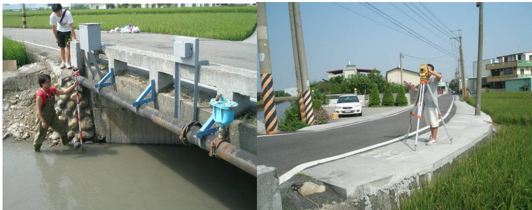
圖5.29 簡易現地河道斷面量測示意圖
