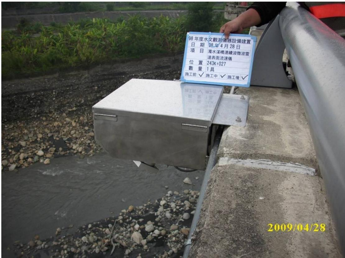
圖C5.4.7 濁水溪橋連續波微波雷達表面流速儀架設完成圖
