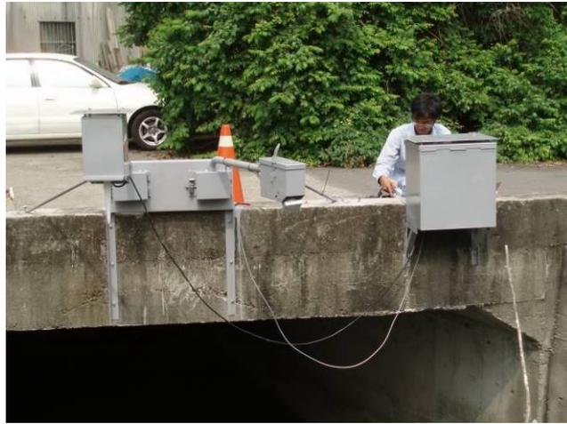
圖C5.4.6 龍船埤排水脈衝式微波雷達流速儀現況圖
