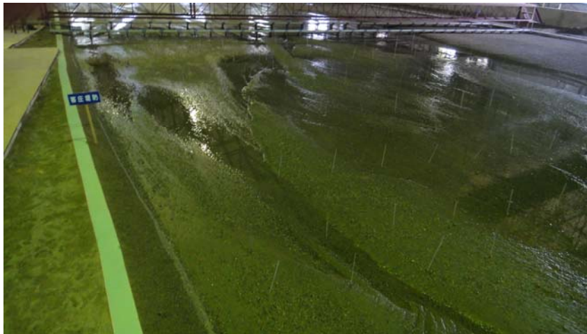
照片 3 100 年重現期砂洲疏濬 300m 方案退水後照片
