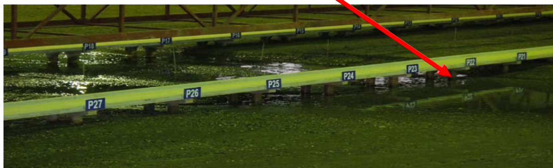
圖5.54 水工模型試驗河中砂洲邊界與現地邊界比較圖
