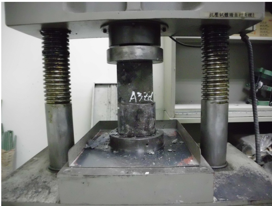
圖 6.12 傾斜剪力試驗試體抗壓情形
