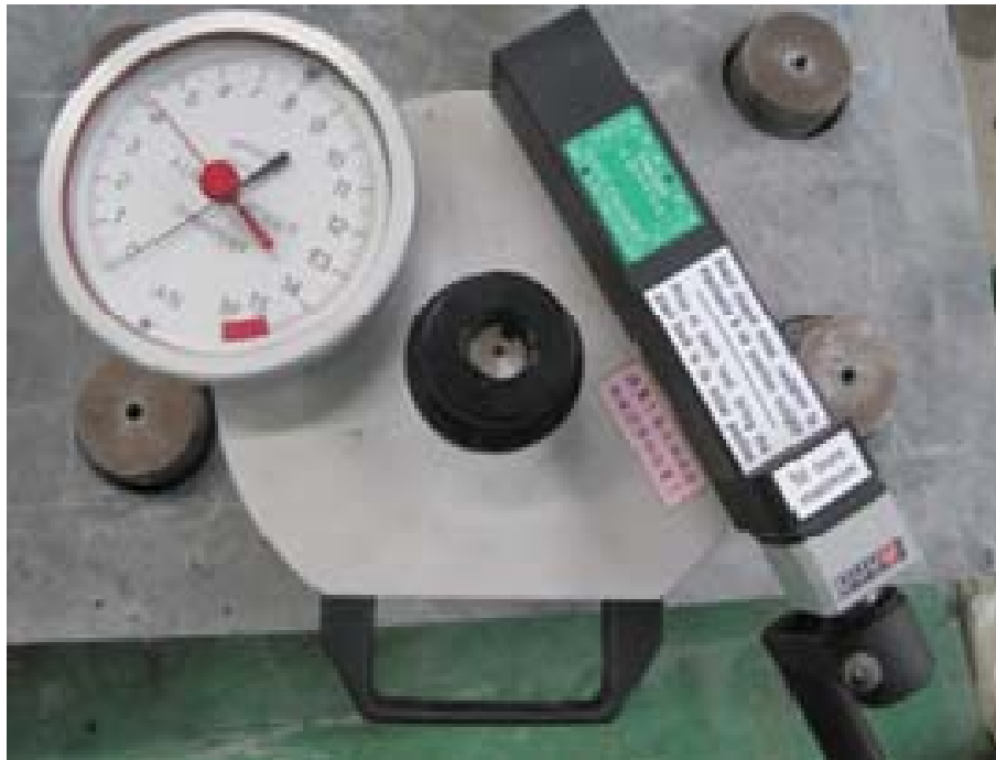
圖 6.8 拉拔試驗儀器
