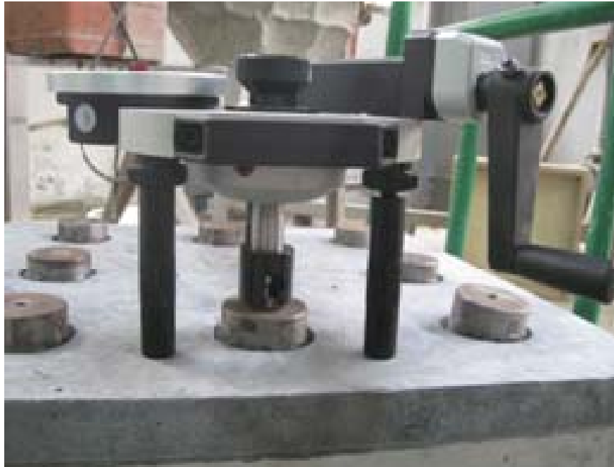
圖 6.9 拉拔試驗情形
