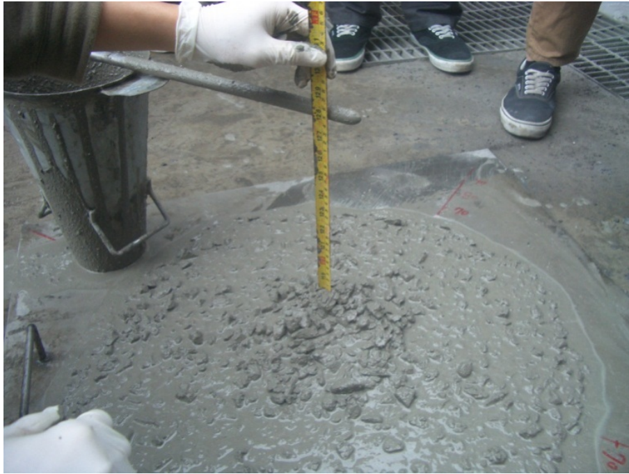
圖 7.1 配比 A3Za 之坍流度情形
