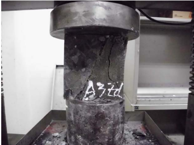
圖 7.32 A3Zd 配比試體抗壓後照片
