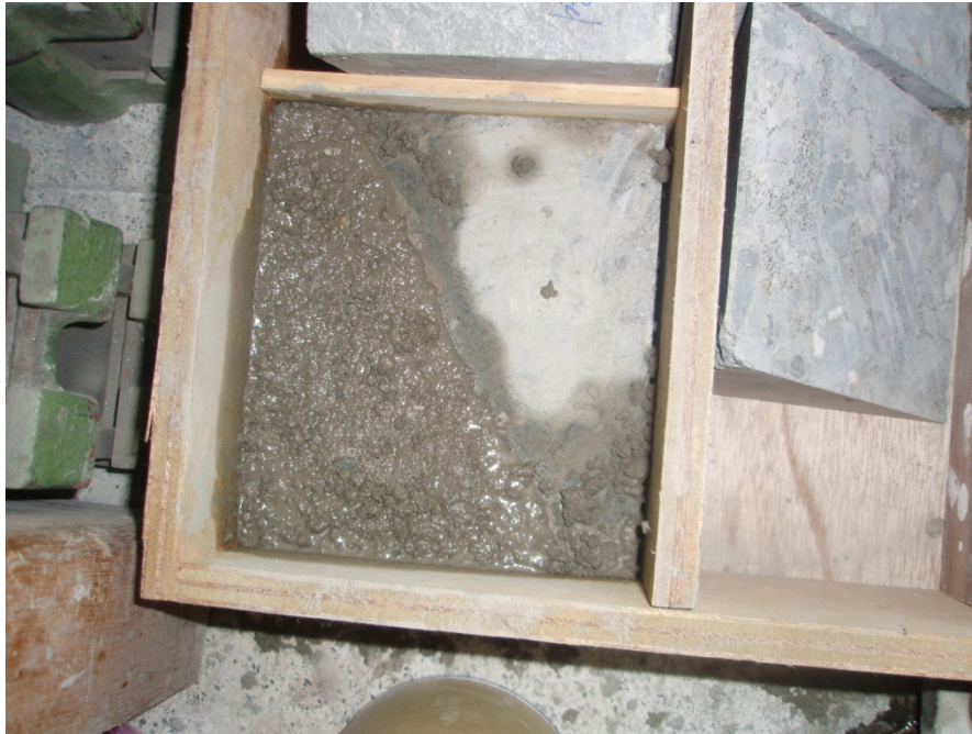
圖 6.11 維修補強材料灌入模具與另一側試體接合情形
