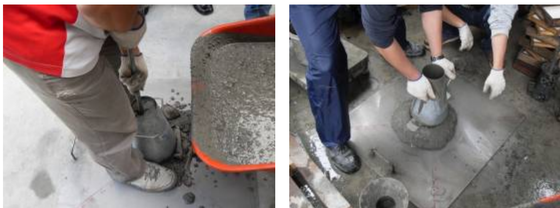
圖 3.5 新拌混凝土坍度試驗
