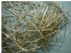
鋼纖維長13 mm，直徑0.2 mm， 長徑比(aspect ratio)為65。
