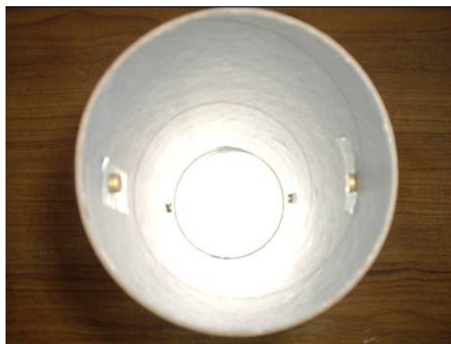
圖 6.4 收縮試驗之試體模具裝置
