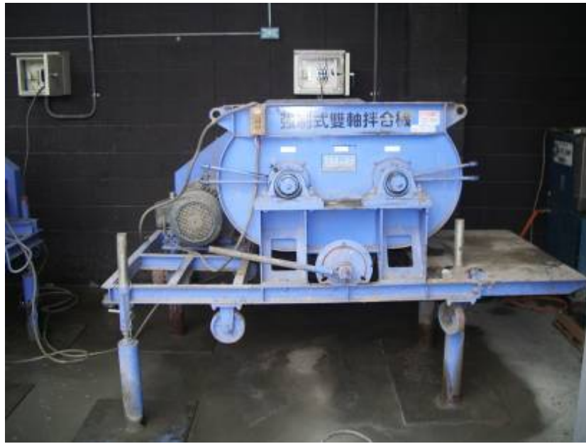
圖 3.27 強制式雙軸拌合機
