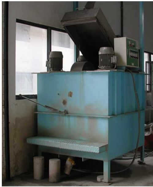
圖 3.10 含砂水沖擊試驗儀
