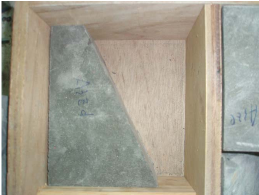
圖 6.10 傾斜剪力水泥砂漿試驗部分放入模具情形
