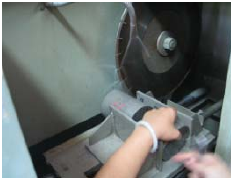
圖 3.13 試體切割機內部構造及切割情形
