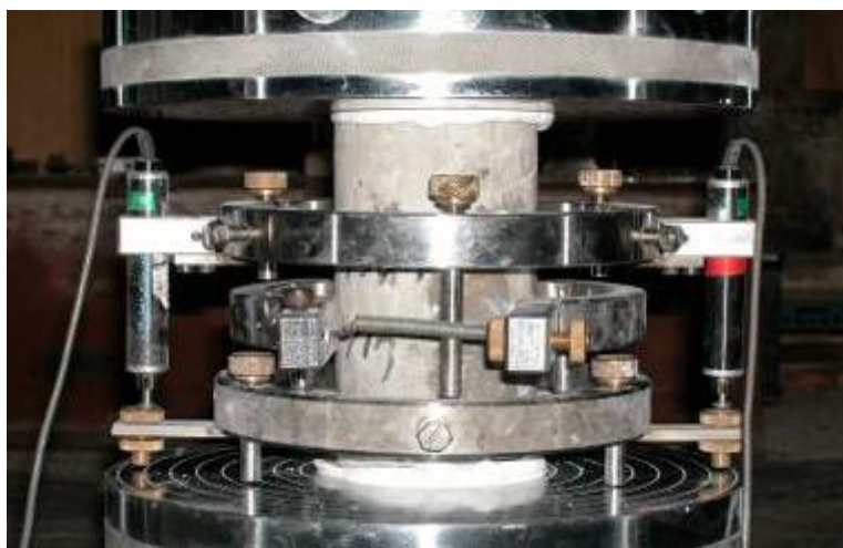
圖 3.8 彈性模數試驗架設
