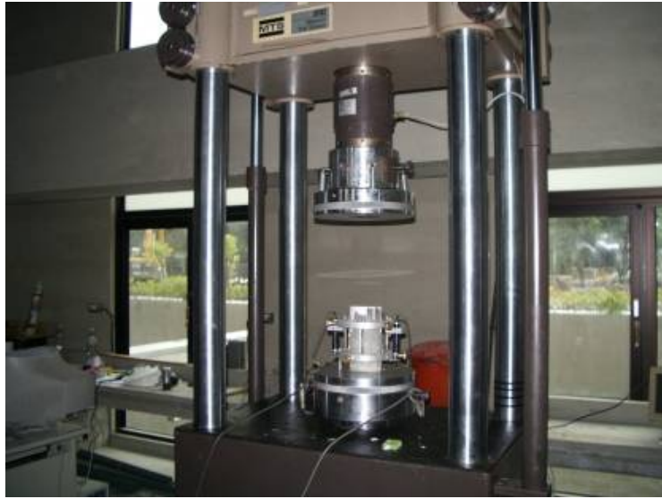
圖 3.7 MTS 萬能材料試驗機
