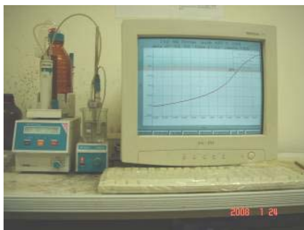
圖 3.20 Metrohm 702 SM 型電位滴定儀
