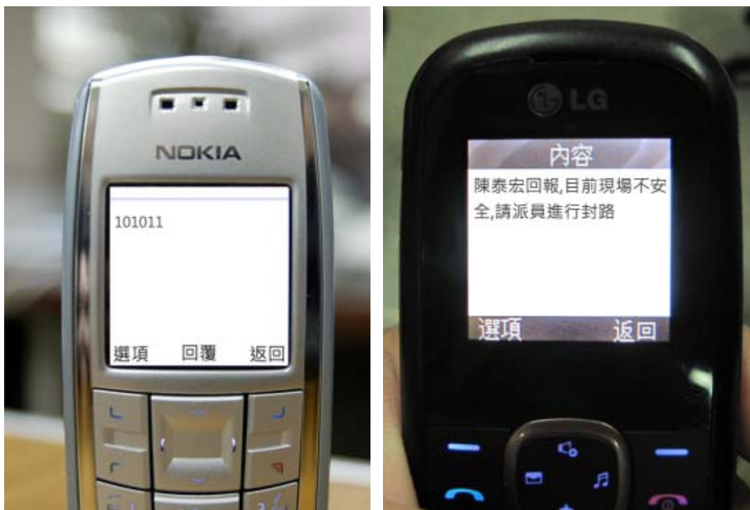
圖 4. 30 巡檢人員發現現場土石崩落道路不安全即刻回傳「101011」(左圖)；系統在接收到代碼後將通知輪職人員派員進行現場封路(右圖)
