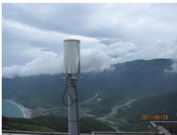
圖 2.1 雨量計架完成
