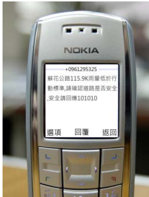
圖 4.31 系統提示巡檢人員現場雨量已低於行動標準，現場道路「安全」請回傳「101010」
