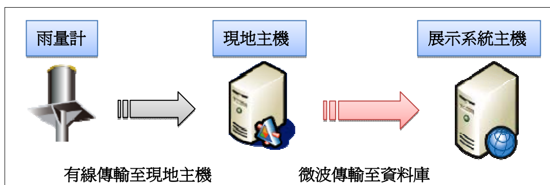
圖 2.9 雨量計資料傳輸與接收架構
