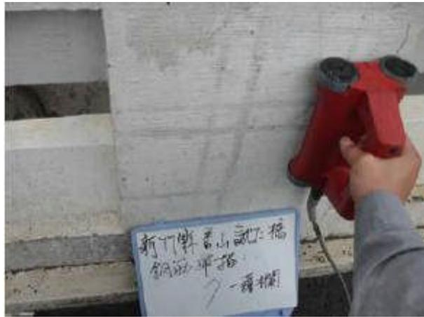
圖 3.12 鋼筋探測儀
