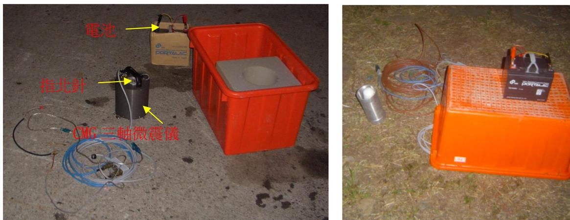
圖 7.54 微地動儀現地試驗圖
