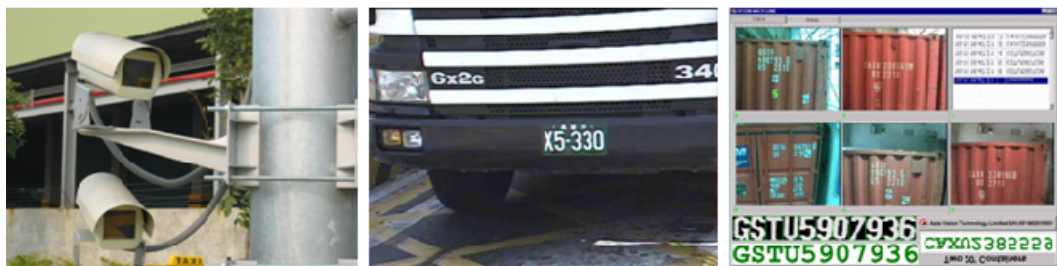
圖 3.4 車號、櫃號辨識系統
