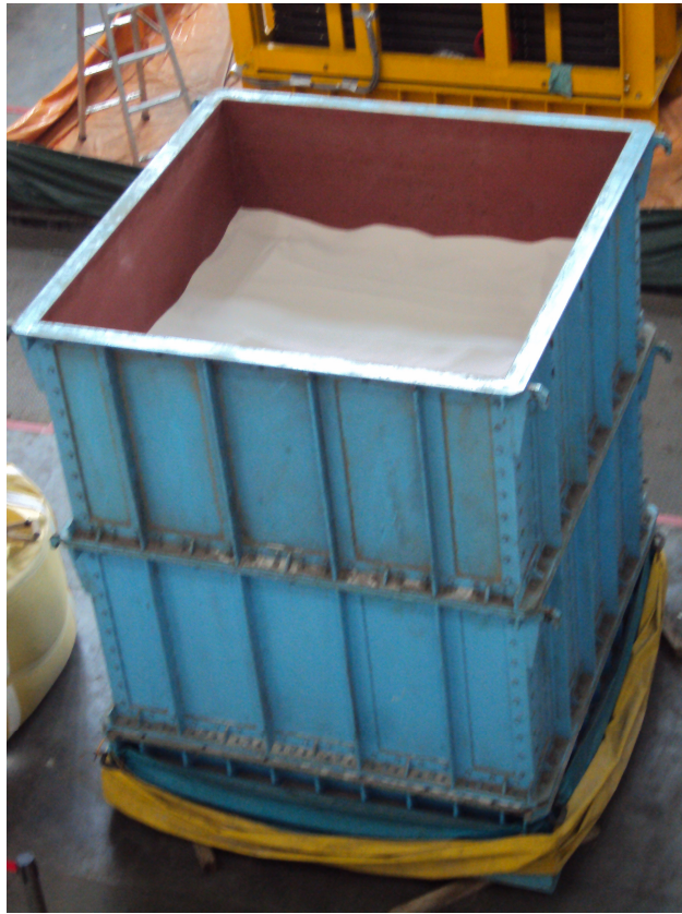
圖 3.14 賈落箱本體裝填欲賈落之越南砂
