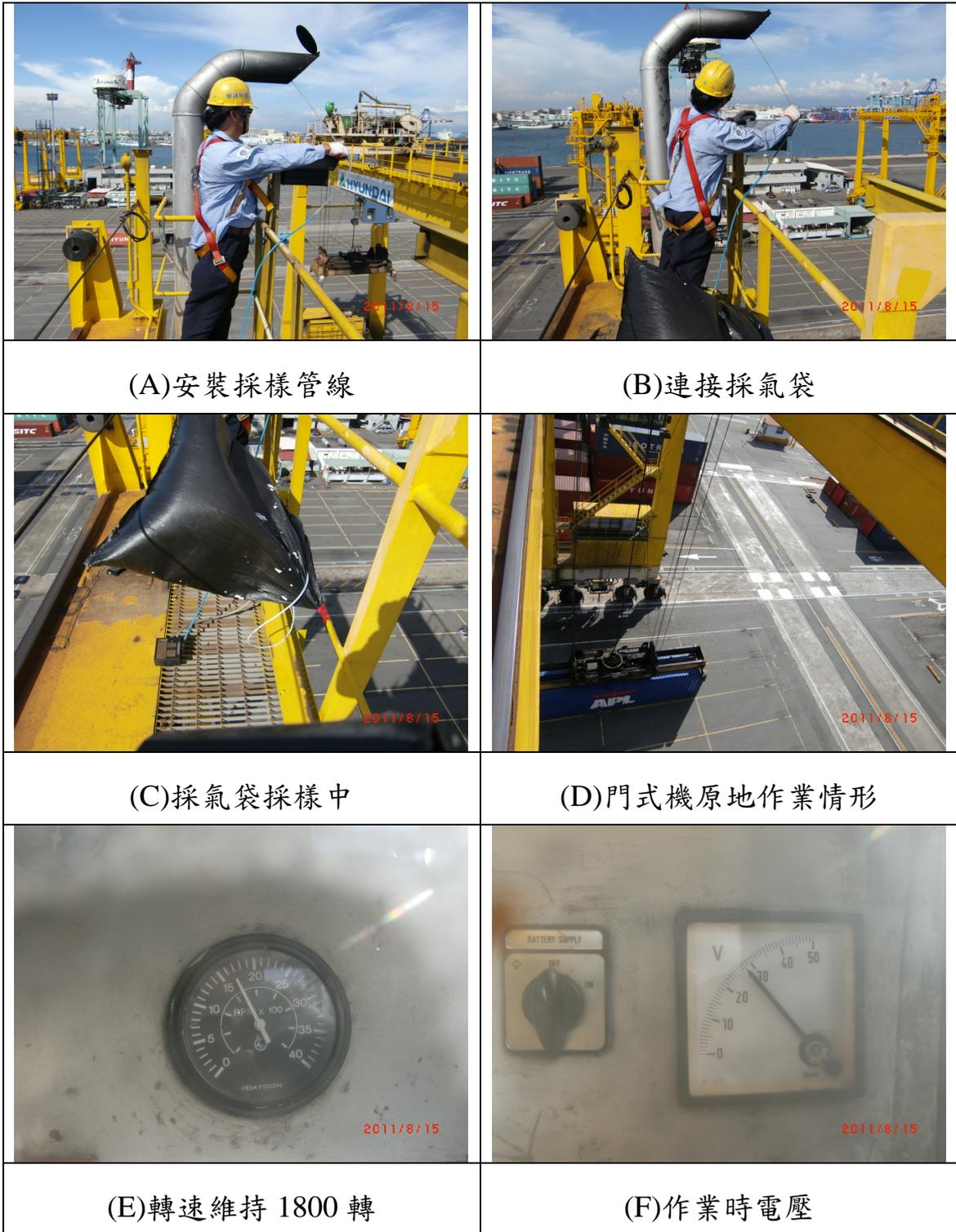
圖5.3 門式起重機採樣情形
