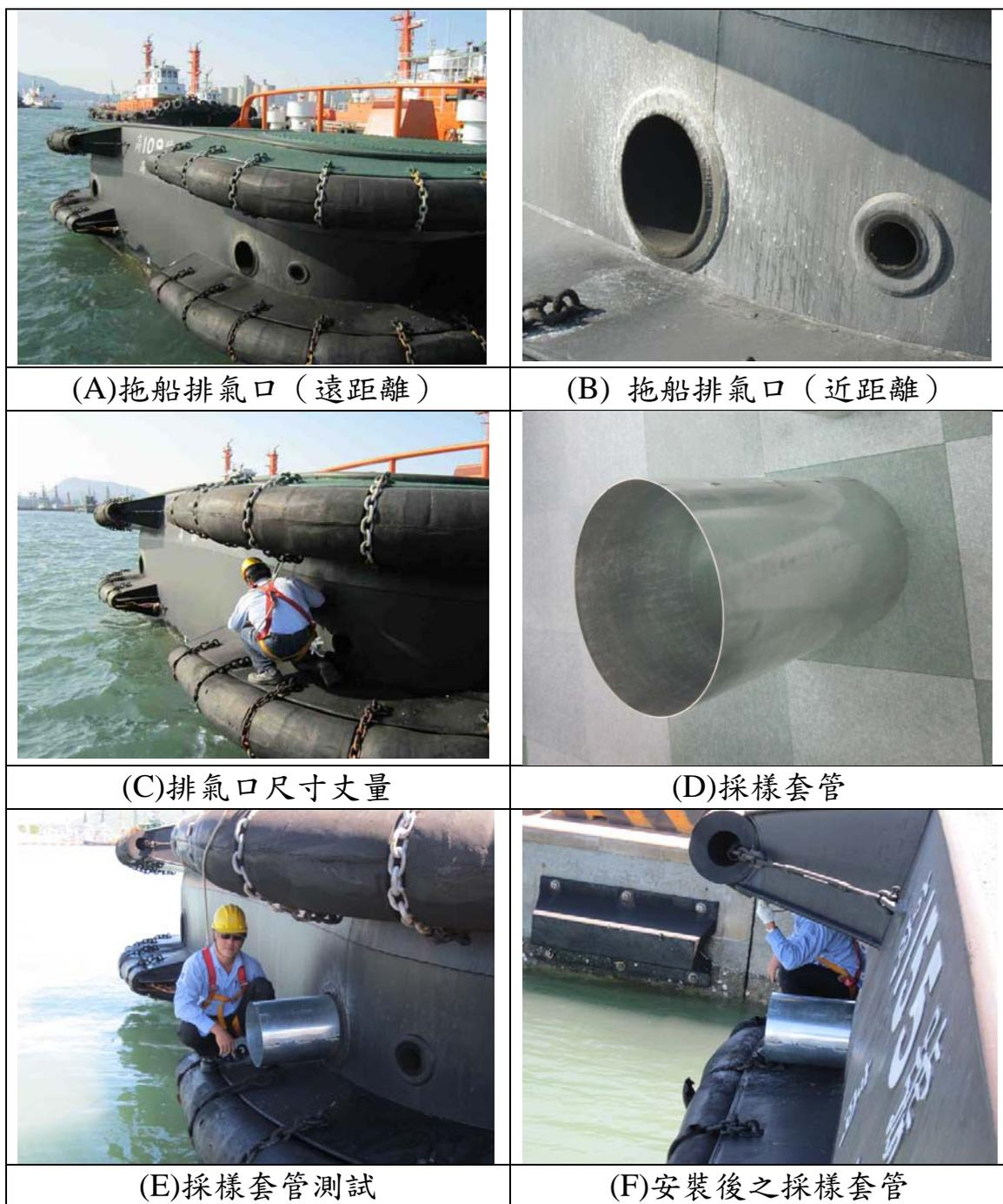
**圖4.6 船舶採樣套管測試情形**
