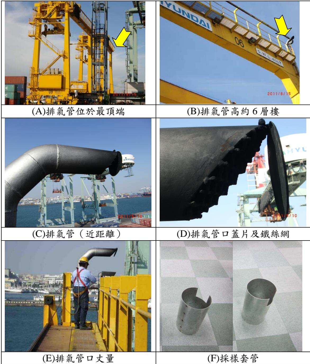
圖5.2 門式起重機排氣管及採樣套管
