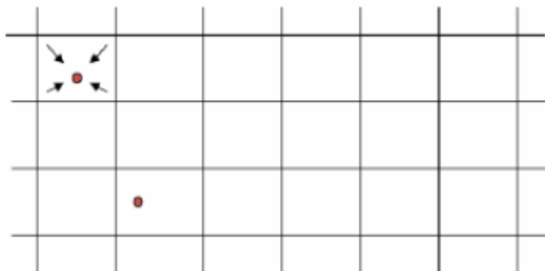
圖 4.4 利用四個網格點計算內插點位代表波浪值之示意圖
