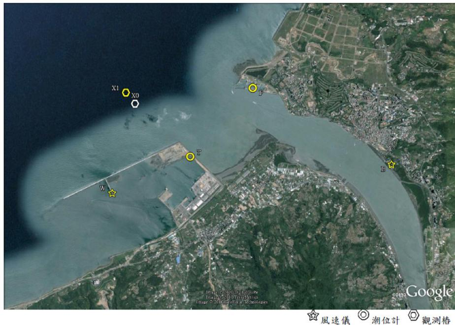
圖 4-8 臺北港海象測站佈置示意圖(蘇 等，2011)
