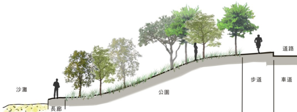
圖 5.40 海岸-公園-道路的斷面概略圖(改繪自日本港灣局，2006 年)
