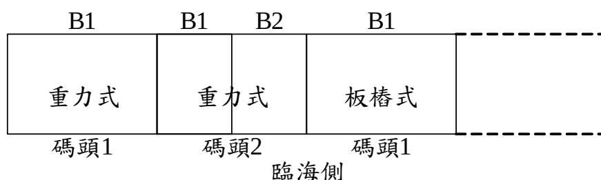
圖 3.10 重力與板樁式碼頭編碼示意
