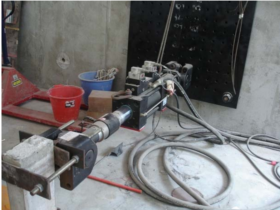
圖 5.22 MTS 油壓系統致動器
