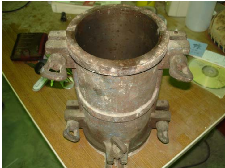
圖 5.18 直徑 12cm 標準圓柱鐵模
