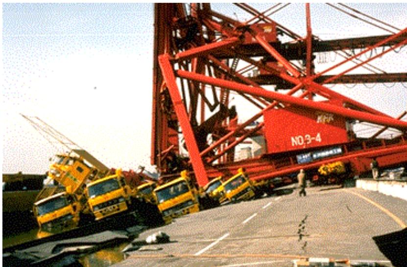
圖 1.1 神戶地震沉箱側移引起設備破壞
