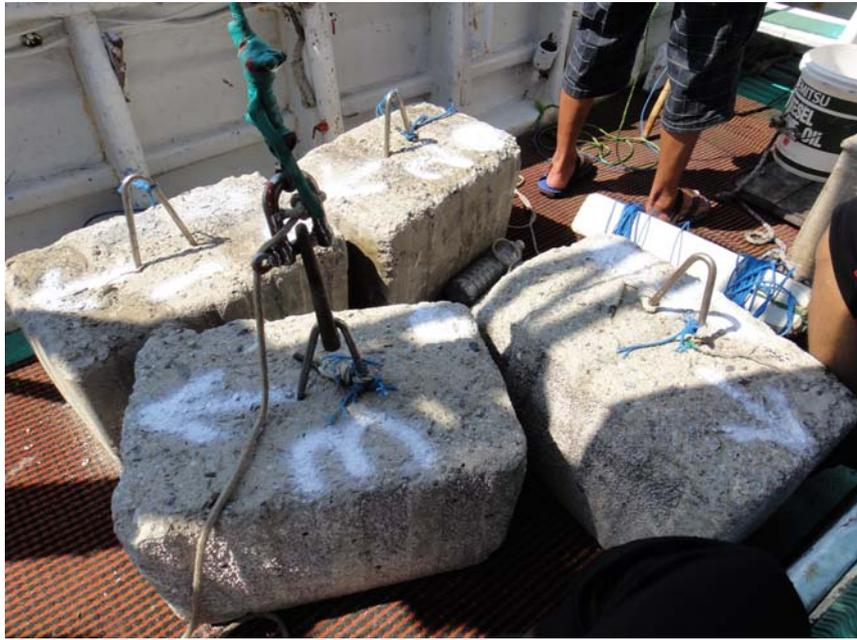
圖 6.6 長基線應答器之定位水泥塊
