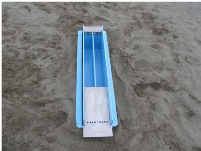
H-2水平式捕沙器量測
