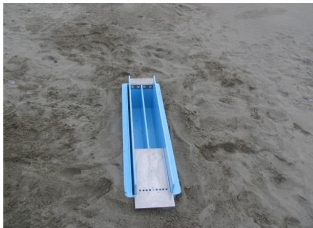
圖 4.5 H-2 型水平集沙器
