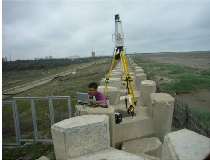
照片 3-5 Lidar 地形測量情形
