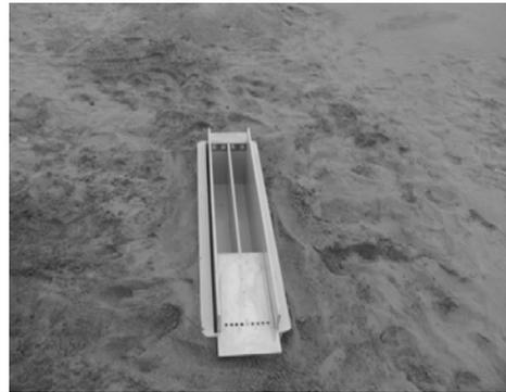
圖 7-5 H-2 型水平集沙器
