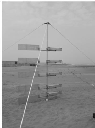
圖 7-6 垂直式沙粒收集器
