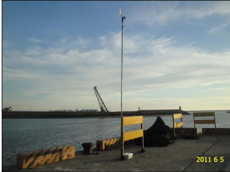
照片 3-1 臺中港港口附近風速風向觀測作業
