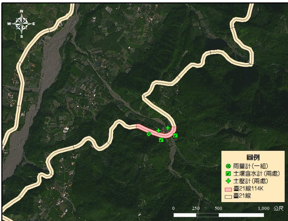
圖12.11 臺21線114K處監測儀器配置圖
