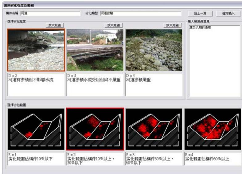
圖 2.20 構件劣化判斷介面
