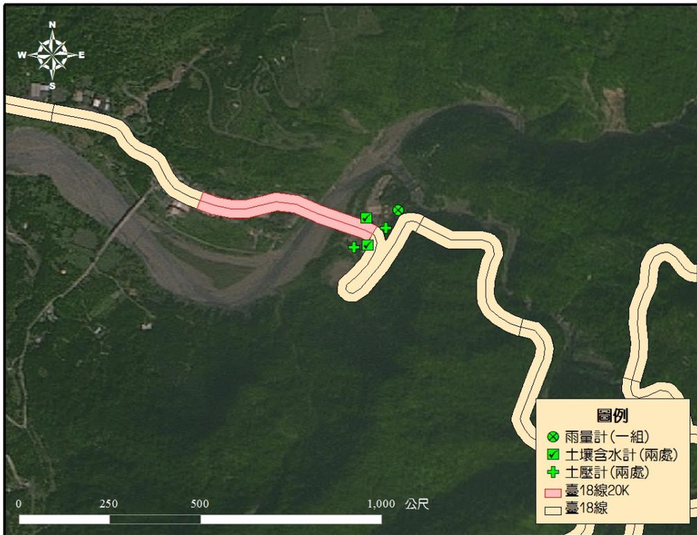
圖12.8 臺18線20K處監測儀器配置圖
