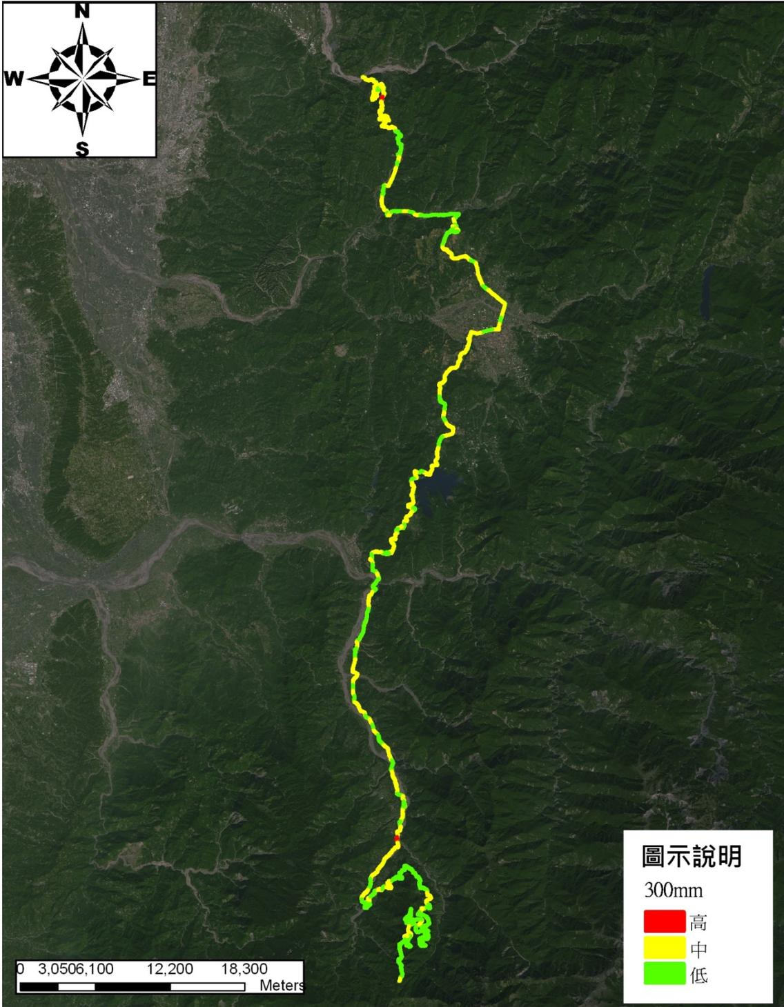
圖 11.9 臺 21 線預測降雨 300 毫米評估示意圖
