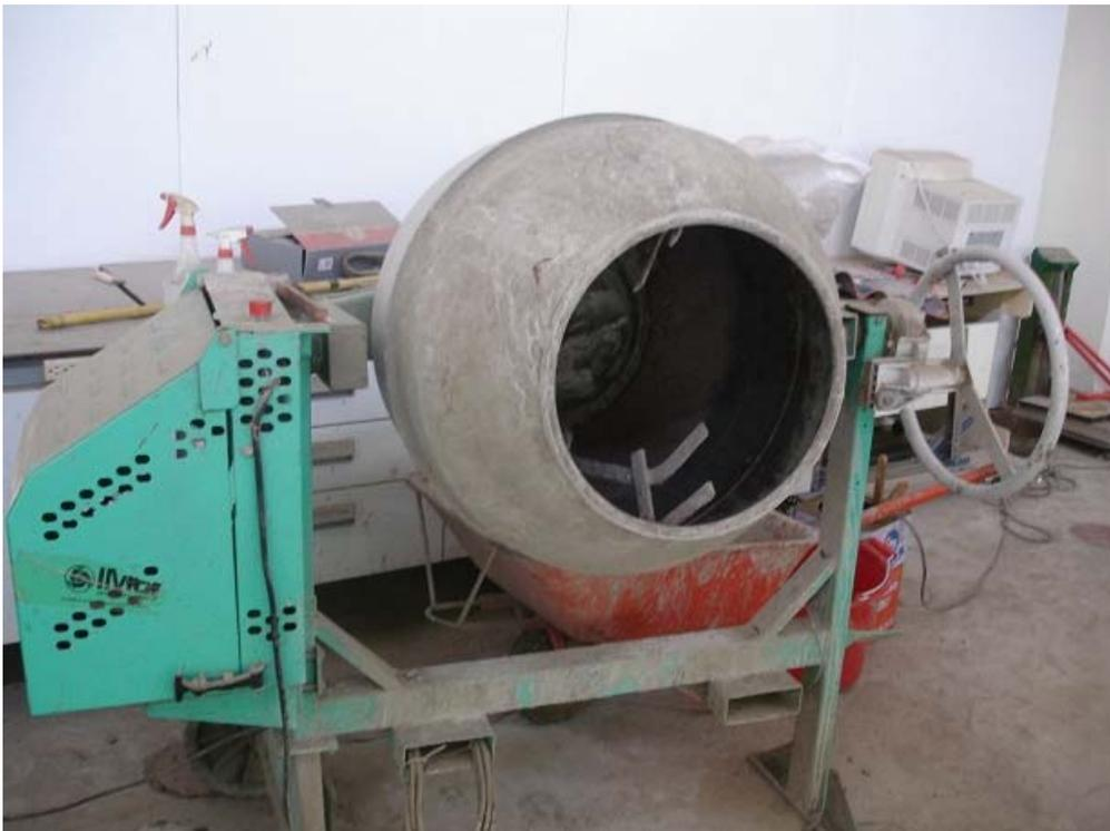
圖 10.21 圓筒式混凝土拌合機
