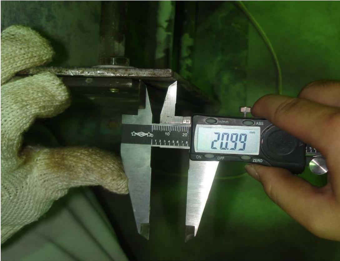
圖 10.14 側板突出部分開口處與根部數值一樣即為鉛直
