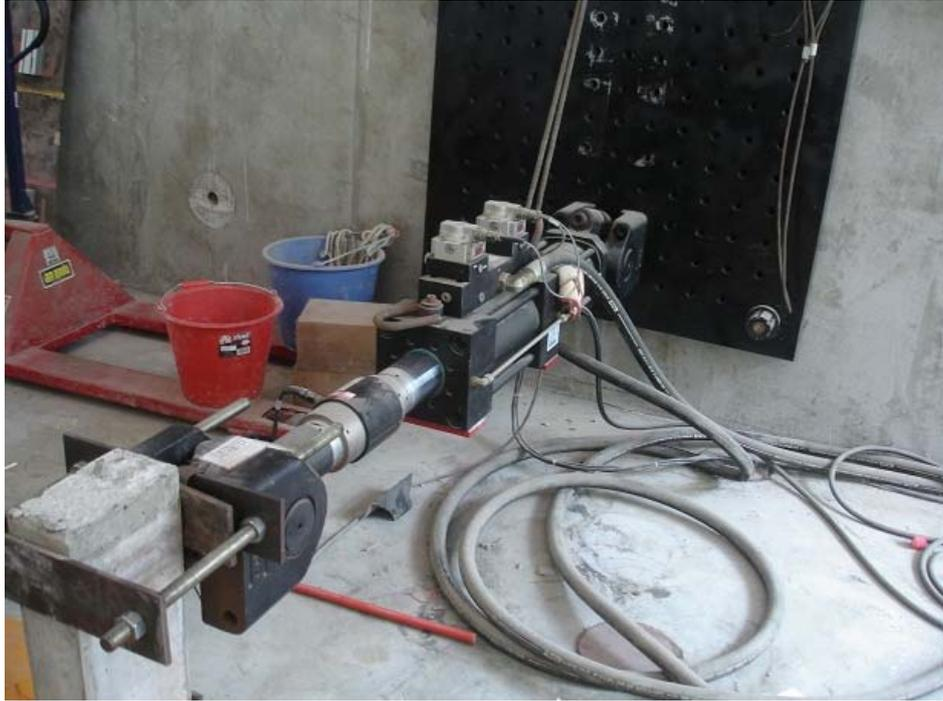
圖 10.22 MTS 油壓系統致動器
