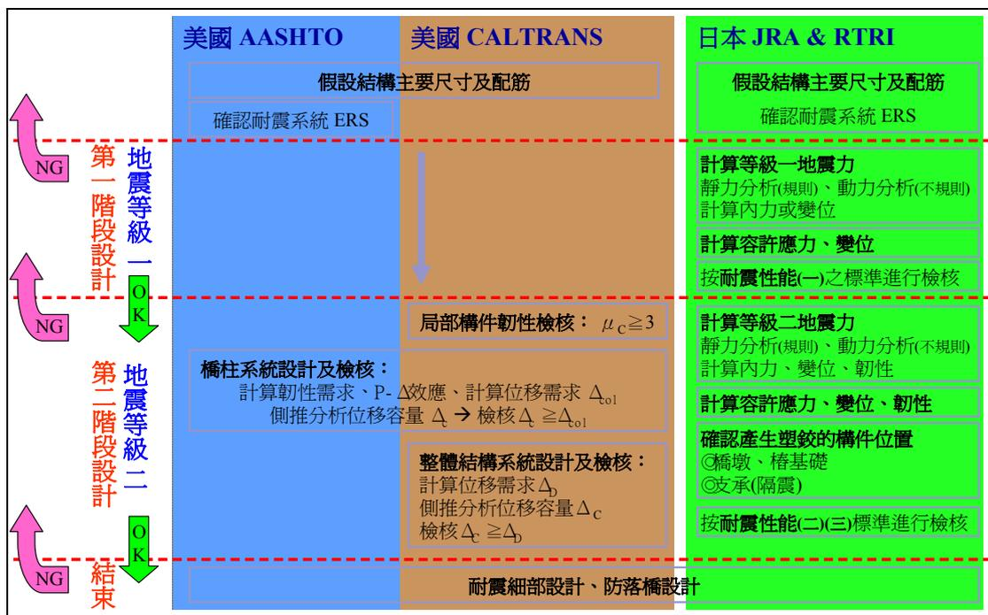
圖 3.24 美日橋梁耐震性能設計流程綜整比較
