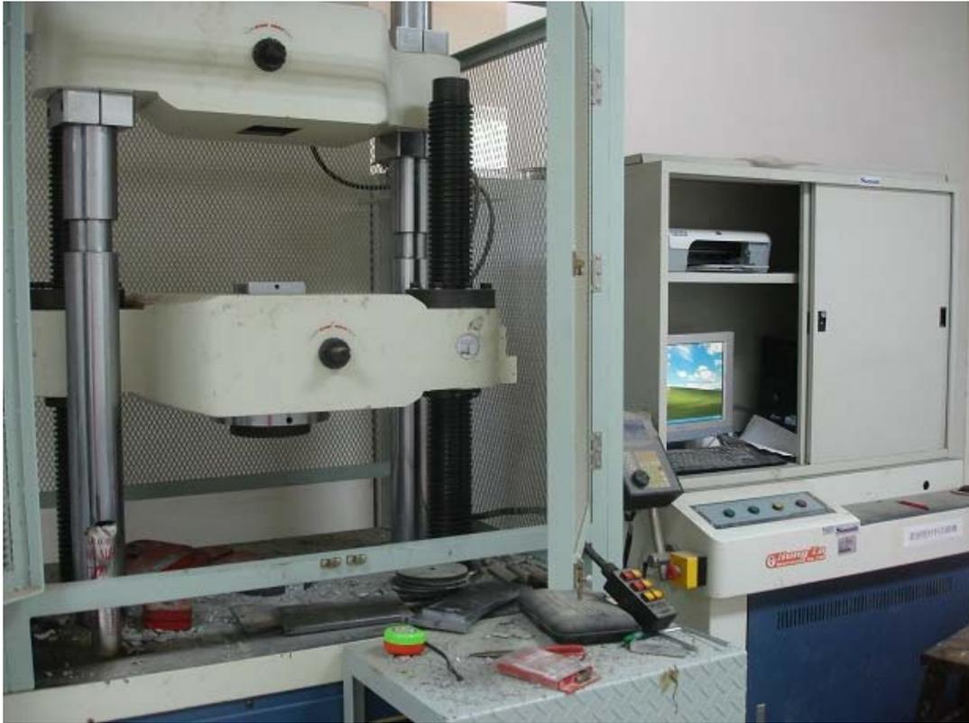
圖 10.26 萬能材料試驗機
