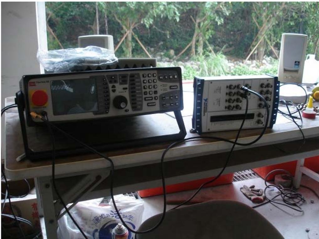
圖 10.23 MTS 控制器及訊號接收器
