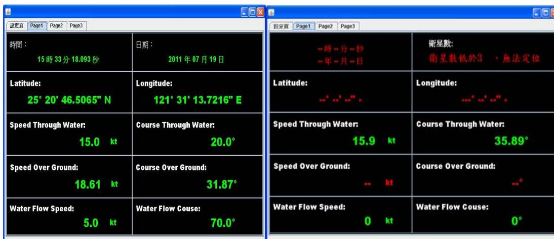
圖 5.12 狀態顯示介面數值顯示模式與衛星定位失效狀況
