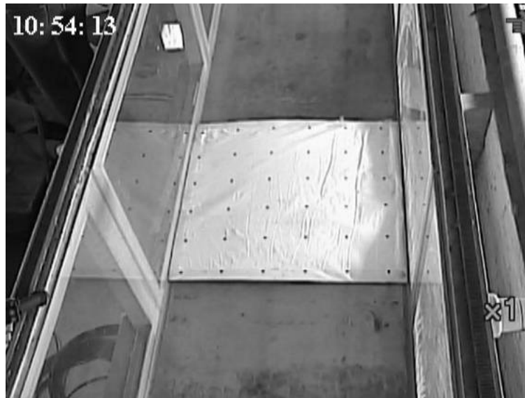
附圖 3.2 渠道流速影像試驗校正板
