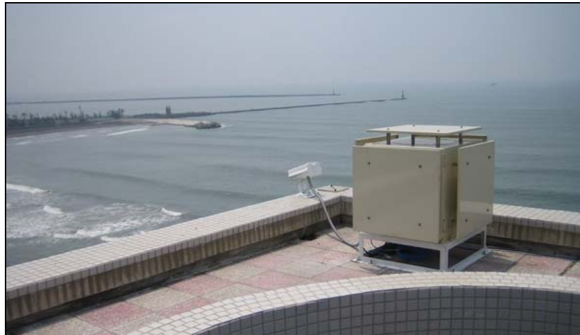
圖 2.1.1 影像儀器設備(攝影機、防水罩與觀測站主機機箱)
