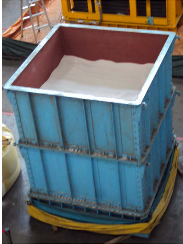
圖 2.14 賈落箱本體裝填欲賈落之越南砂
