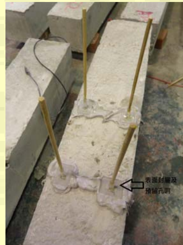
以表面封層配合針筒注射修補工法完成圖
