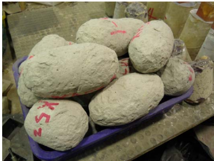
圖 4.8 壓克力樹脂改性漿體洛杉磯磨損試驗剩餘質量圖
