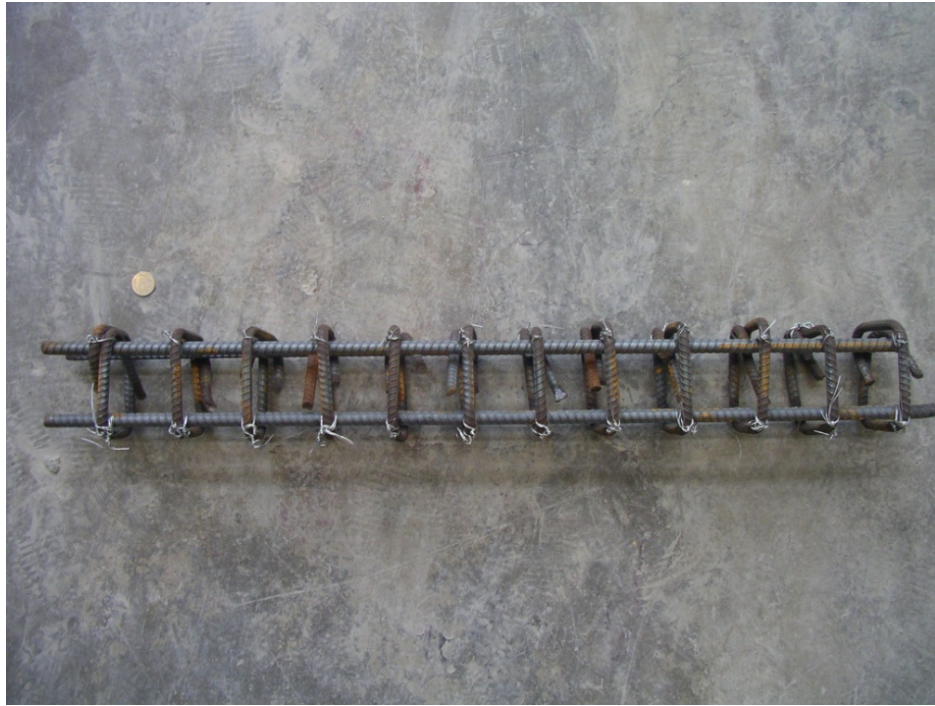
圖 3.7 內容物鋼筋外觀
