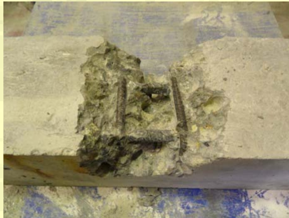
以電鑽破壞通電加速腐蝕試體圖
