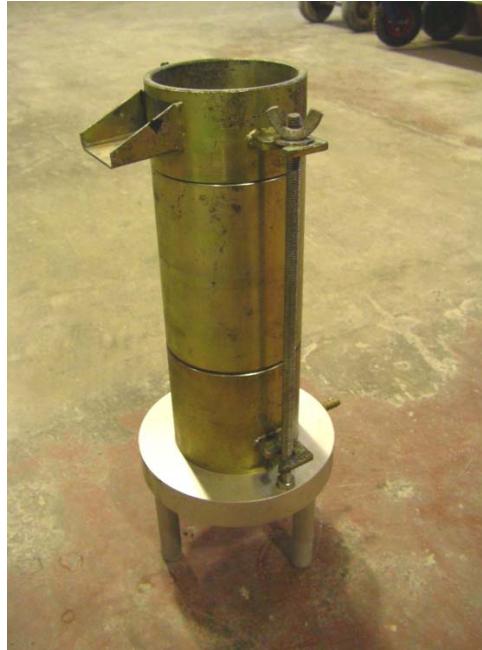
圖 3.19 定水頭透水係數測定儀
