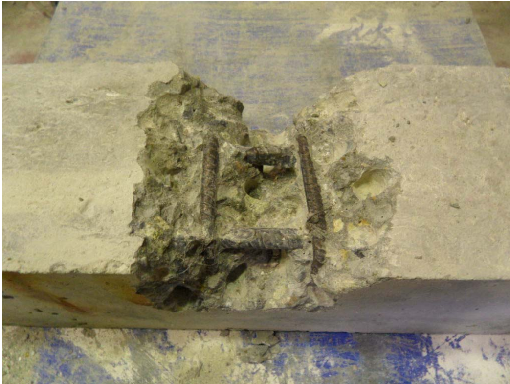
圖 4.16 以電鑽破壞通電加速腐蝕試體圖
