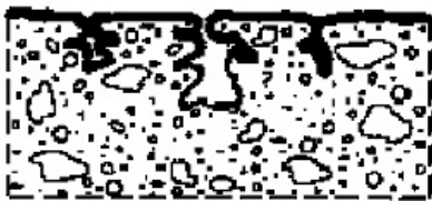
圖 6.1 表面注入法示意圖
