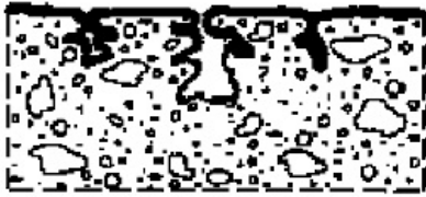
圖 5.78 表面注入法示意圖
