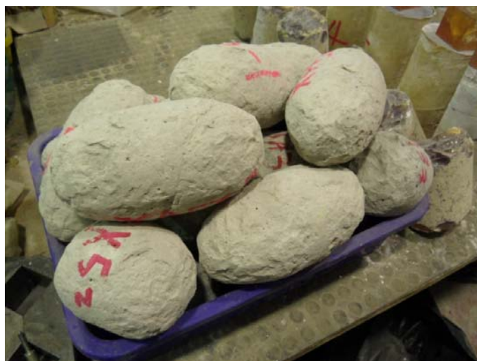
圖 5.61 壓克力樹脂改性漿體洛杉磯磨損試驗剩餘質量圖
