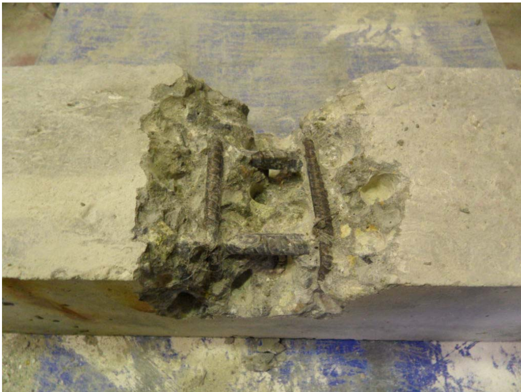
圖 5.69 以電鑽破壞通電加速腐蝕試體圖
