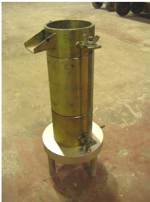
圖 5.41 定水頭透水係數測定儀
