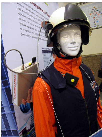
圖4.5 WiMAX 之移動式救災設備
