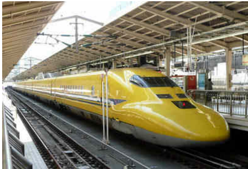
圖2.11 東海道新幹線檢測車使用 EMU923 機車
