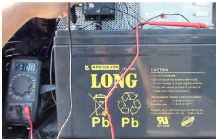
(1)利用電表檢測電池電壓
