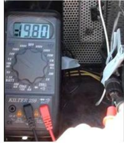
(2) 利用電表檢測太陽能板電壓
