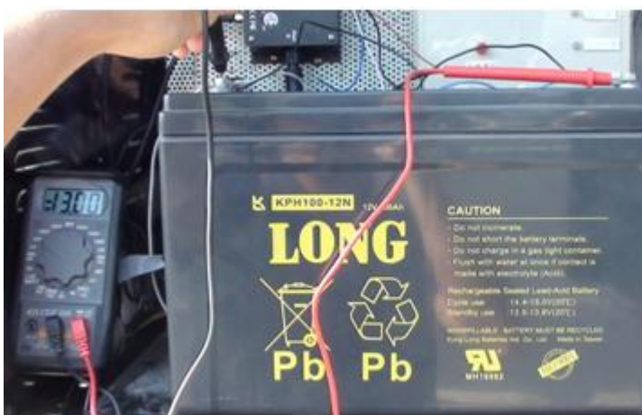
(1) 利用電表檢測電池電壓
