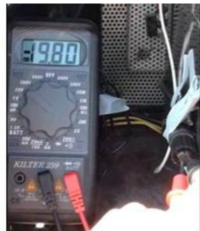
(2) 利用電表檢測太陽能板電壓
