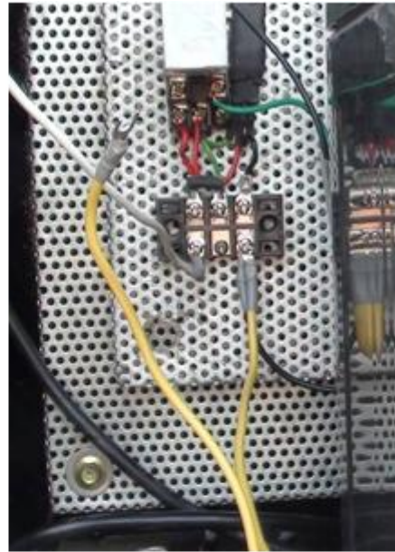
(2) 拔除迴路接頭進行測試
