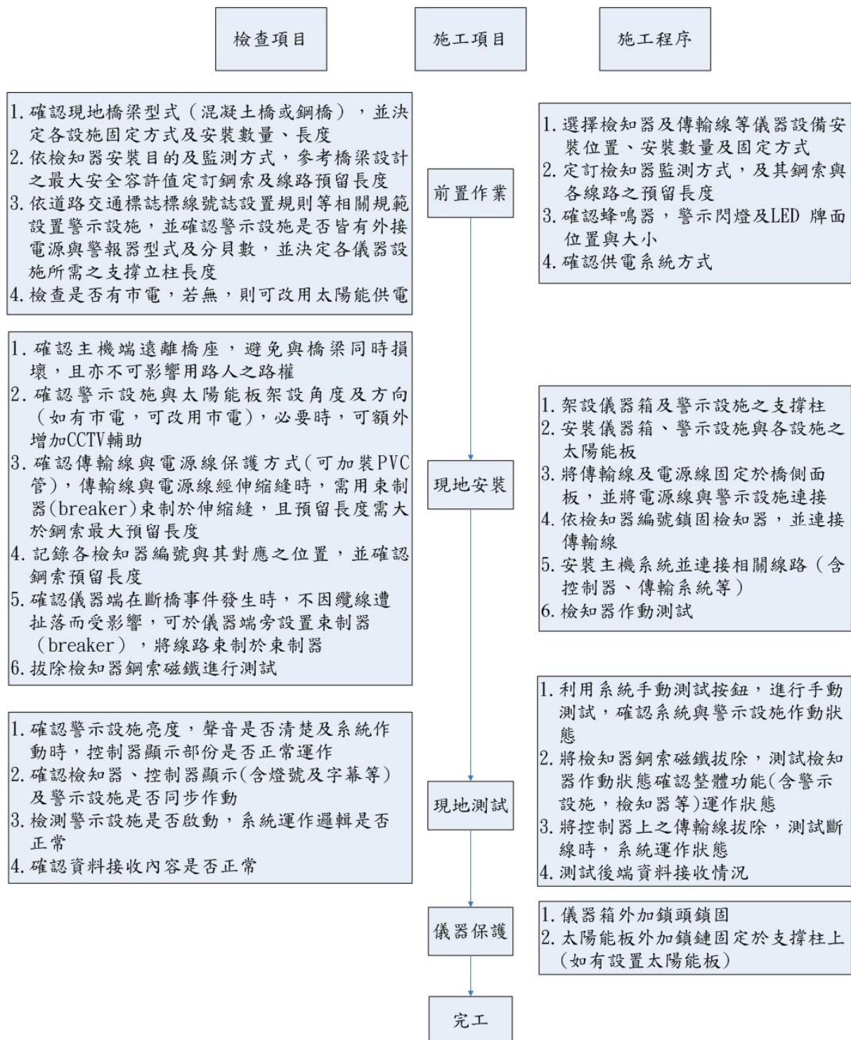
圖 1 檢知器警示系統現地安裝流程
