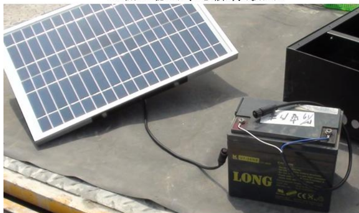
(2)電池及太陽能板接頭規格化
