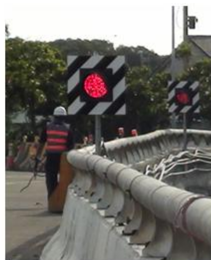
(4) 測試警示閃爍作動情形
