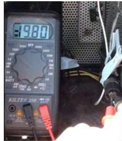
(2)利用電表檢測太陽能板電壓
