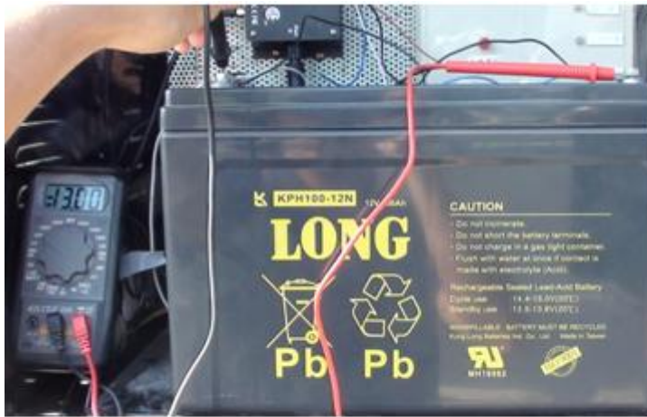
(1) 利用電表檢測電池電壓
