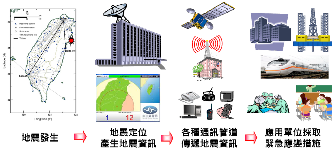
圖 3.4.2 強震即時警報系統之架構
