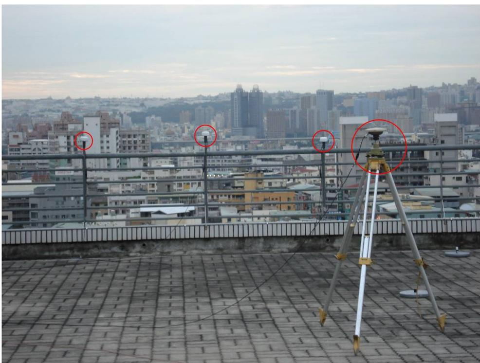
圖 3.8 修改後多天線 GPS 位置配置圖
