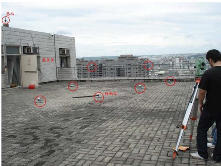
圖 3.5 多天線 GPS 試驗配置圖
