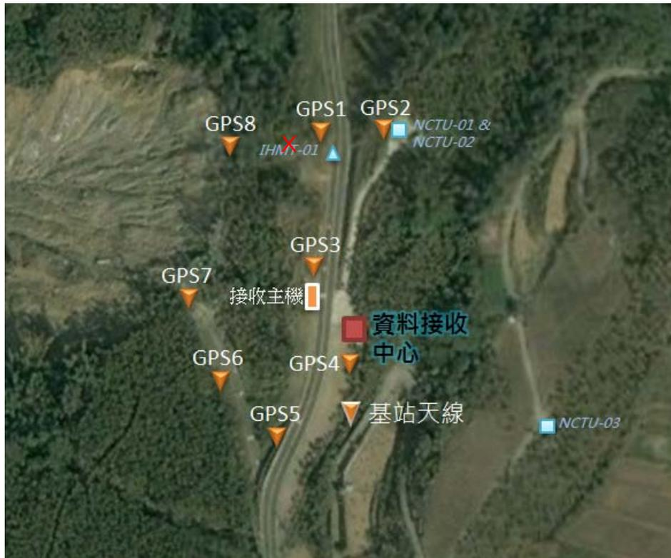
圖 3.3 第 6 彎現地 GPS 天線儀器配置圖
