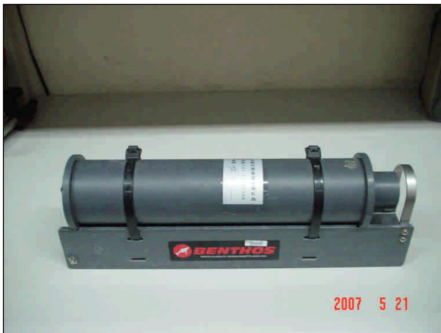
圖 3-8 繫留觀測使用之釋放儀
