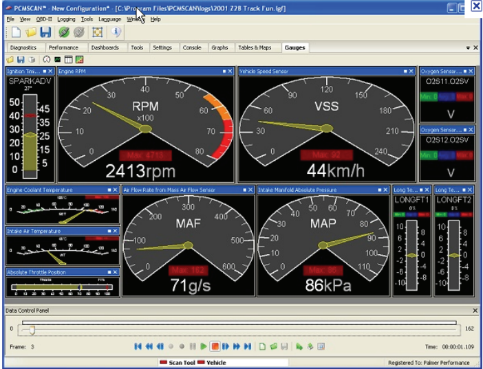
圖 3.7 PCMSCAN 偵測軟體所顯示的即時數據變化情形
