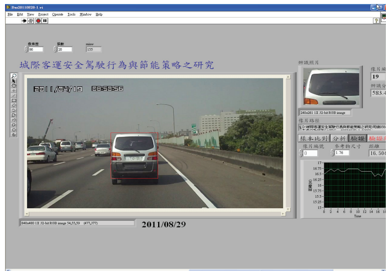
圖 3.37 半自動辨識換算跟車距離程式介面
