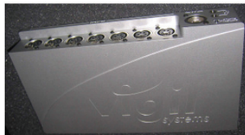
Hub：用來連接四臺攝影機+ 衛星定位器+慣性感應器
