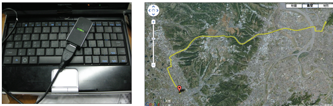
圖 3.5 GPS 衛星接收器與行車過程行駛路線軌跡
