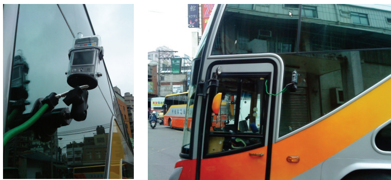
圖 3.1 車側行車紀錄器架設情形
