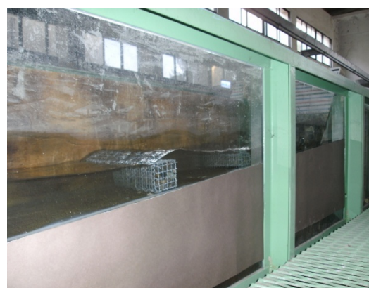
圖 5.5.24 雙潛堤之試驗情形
