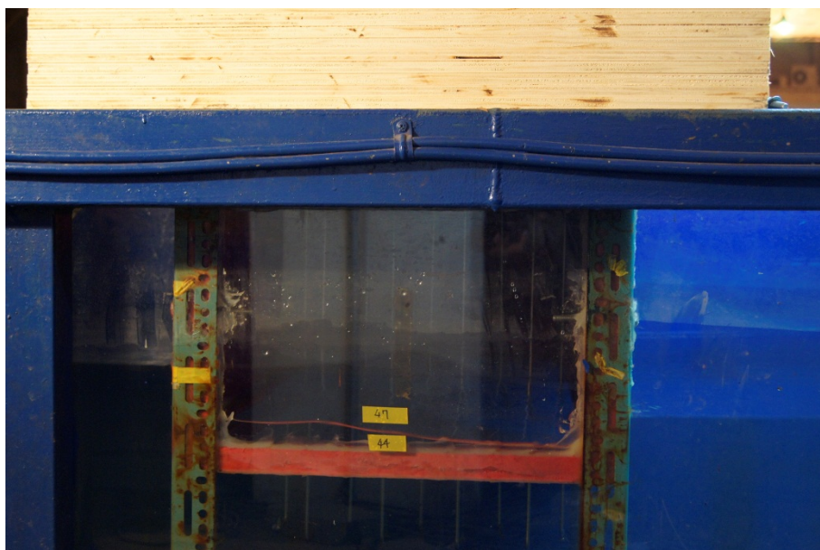
照片 3.4.1 試驗造波時浮箱內外的水位變化差異情形
