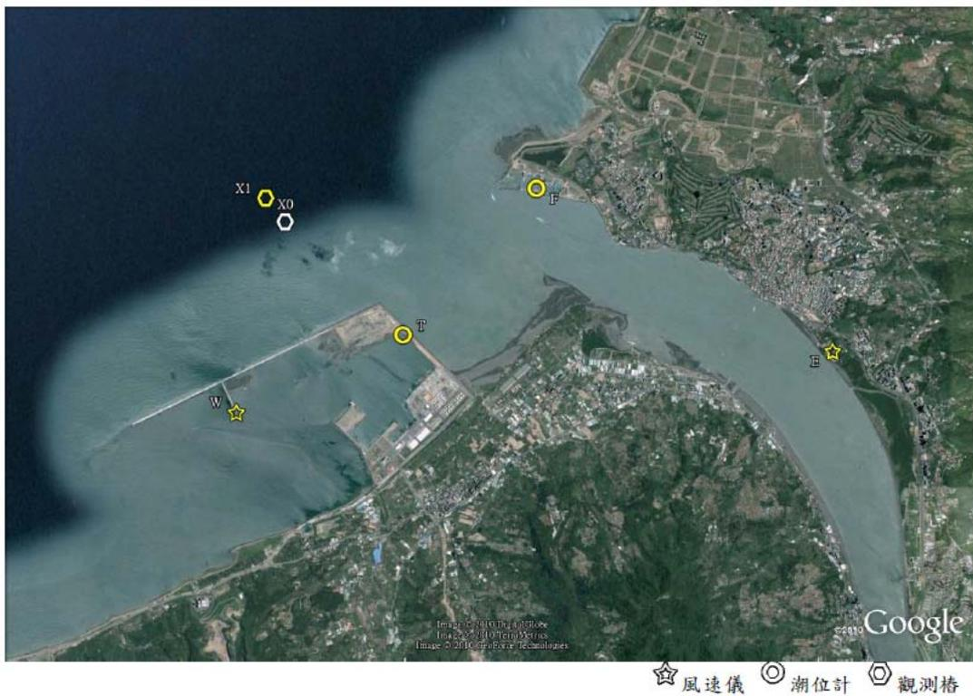
圖 3-9 台北港海氣象觀測站儀器安裝佈置示意圖(蘇等人，2011)
