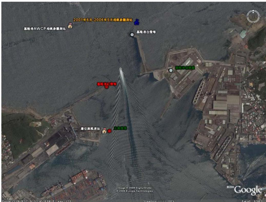
圖 3-3 基隆港海氣象觀測站儀器安裝佈置示意圖(曾等人，2011)
