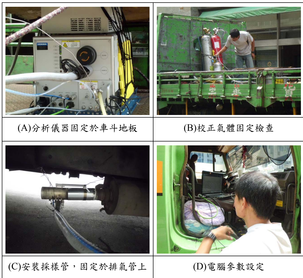
圖 5.2 OBS 設備安裝情形
