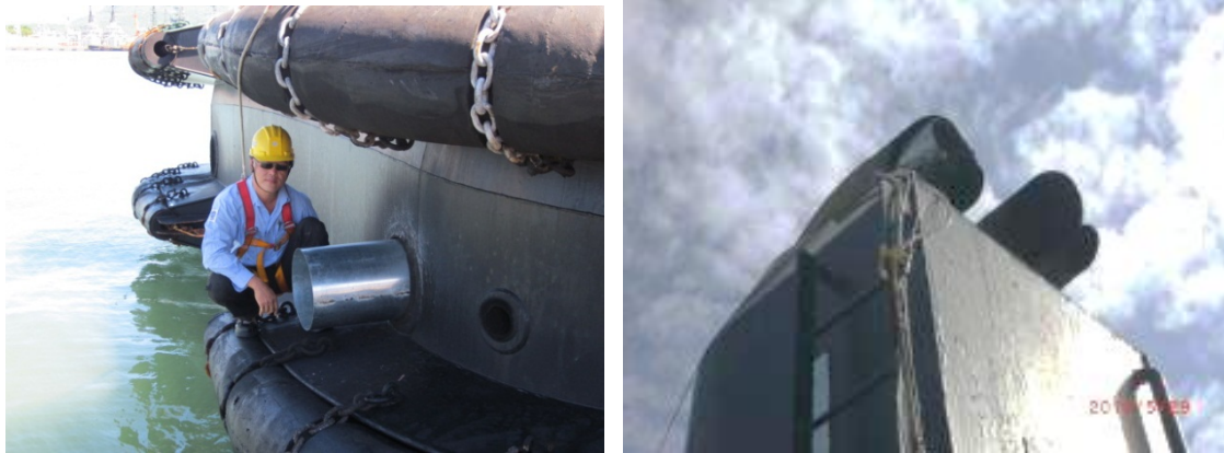
圖 3.6 拖船之採樣套管
