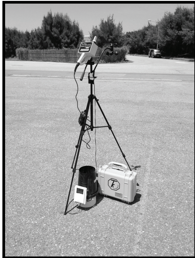
圖 3.6 DustMate 激光粉塵監測儀
