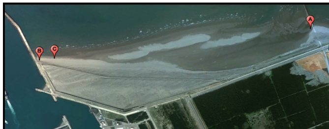
臺中港北淤沙區飛沙量測位置圖
