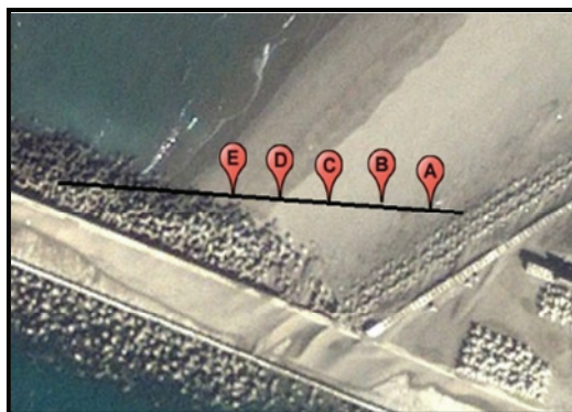
北防波堤飛沙越堤試驗地點圖 (50 m、間隔10 m、方向朝北)
