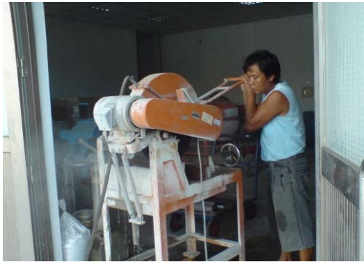
圖 4.5 鑽心試體切割
