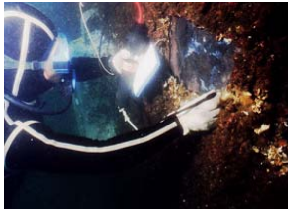
圖 4.13 水面下量測鋼板樁厚度之情形
