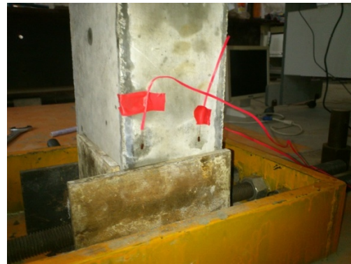
圖 3.6 Strain Gauge 擺放位置
