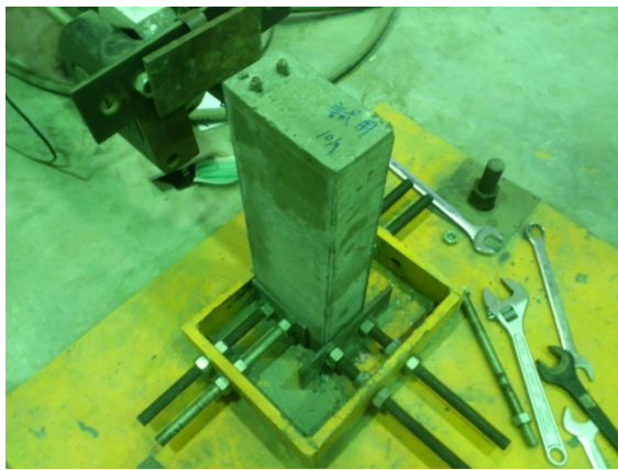
圖 3.7 以螺絲系統將 RC 柱鎖死於底板上
