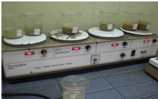
圖 4.9 混凝土粉末浸泡於蒸餾水煮沸
