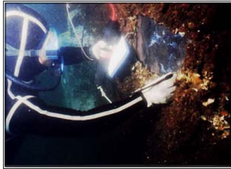
圖 2.26 水面下量測鋼板樁厚度之情形
