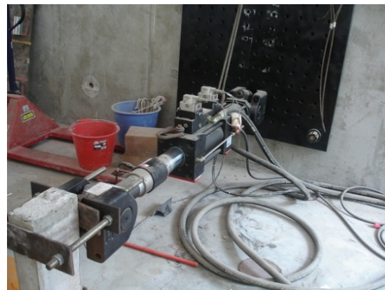
圖 3.8 MTS 油壓系統致動器作用於構件模型
