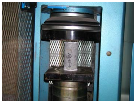
圖 4.7 試體之抗壓試驗
