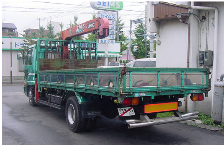
圖 2.4 積載型貨車起重機示意圖
