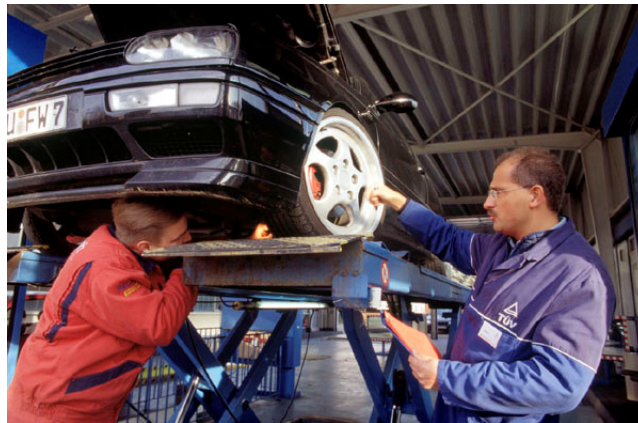
圖 3.11 德國底盤檢查(以頂車器舉起小型車)
