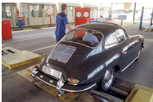
圖 3.7 德國煞車檢測(後輪)
