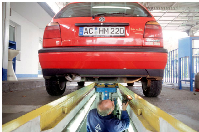
圖 3.12 德國底盤檢查(以地溝進行檢查)
