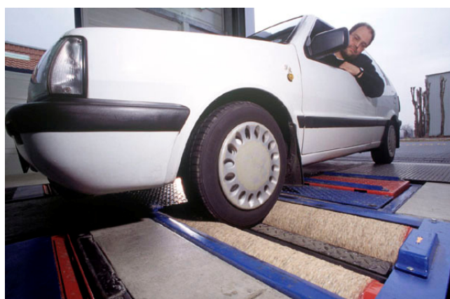
圖 3.6 德國煞車檢測(前輪)
