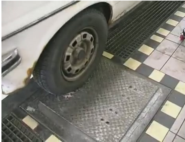
圖 3.10 德國底盤檢查(以鐵盤小幅搖動車輛)
