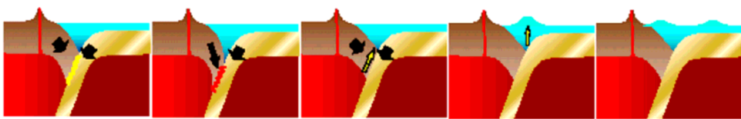
圖 2.5 板塊交界處發生錯動後引起海嘯之示意圖
