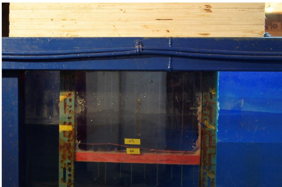
照片 3.3.1 試驗造波時浮箱內外的水位變化差異情形
