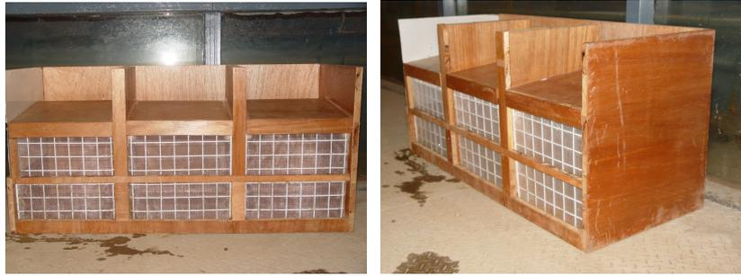
照片 2.2.1 內建斜坡式消能結構物實體模型
