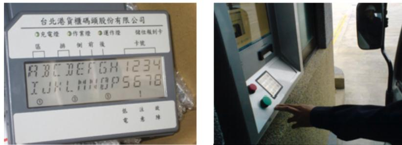
圖 3.6 無線感測卡(Zigbee Card) 與發卡 Kiosk
