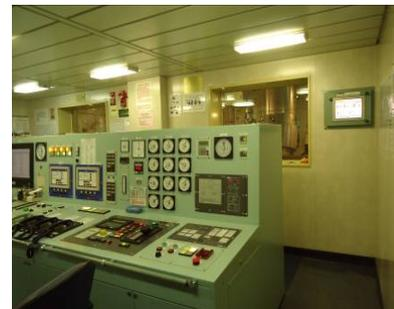
圖 5-7 監測與控制系統
