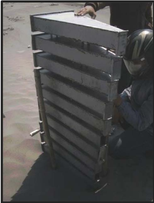
圖 6-5 垂直式沙粒收集器
