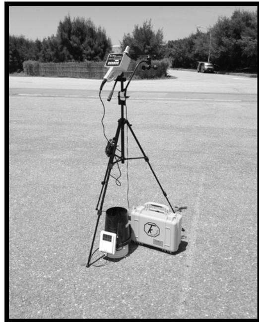
圖 6-6 DustMate 激光粉塵監測儀
