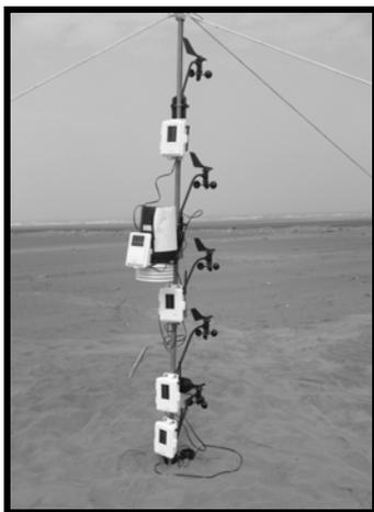
圖 6-2 風速風向觀測儀圖
