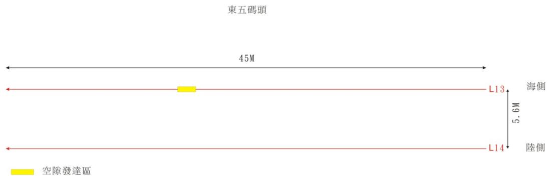
圖 4.115 基隆港東五號碼頭透地雷達探測成果示意圖
