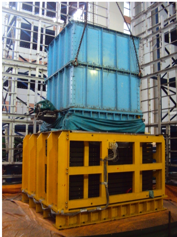
圖 2.4 以質落裝置進行試體準備
