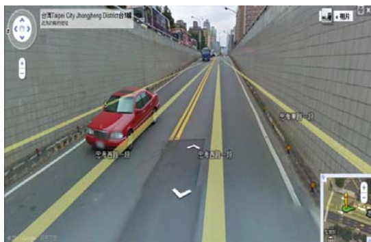
圖 3-5 臺北市中正區忠孝東西路地下道之車道配置（單向 1 汽車道）
