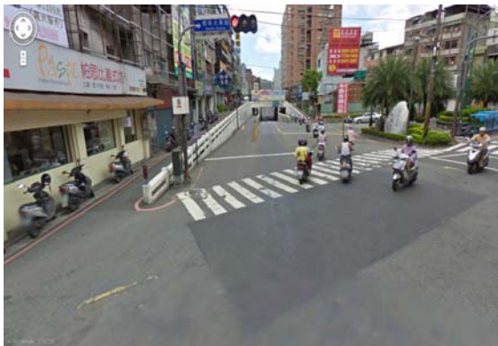
圖 10-7 新北市樹林區保安街一段地下道之車道配置（1 快車道、1 機車專用道）
