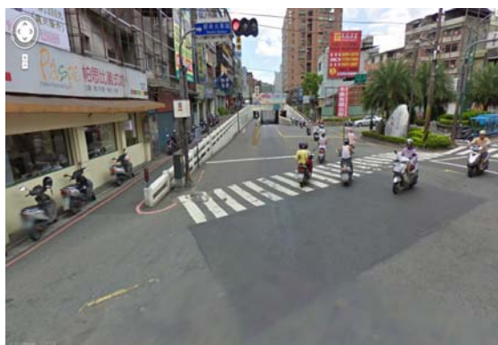
圖 3-7 新北市樹林區保安街一段地下道之車道配置（1 快車道、1 機車專用道）
