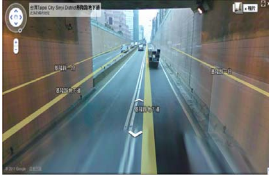
圖 3-1 臺北市信義區基隆路地下道之車道配置（2 快車道/禁行機車）
