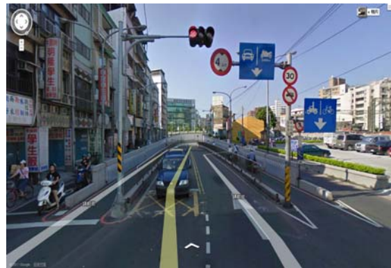
圖 10-8 新北市樹林區八德街地下道之車道配置（1 快車道、1 機車專用道）
