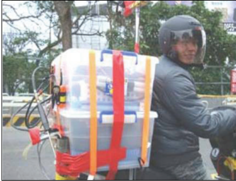
圖 2.5.4 環保署機車實測所採用之車載量測系統
