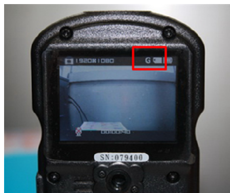
圖 5.9 行車記錄器已接收到 GPS 訊號之畫面
